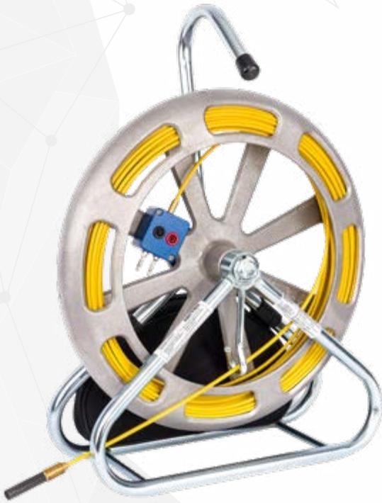
La recherche de tubes non conducteurs est simplifiée avec l'aiguille détectable et le système de sonde. Les points et les lignes sont déterminés avec le système de localisation universel. L'émetteur est connecté via deux câbles au boîtier de connexion de la bobine de positionnement.
