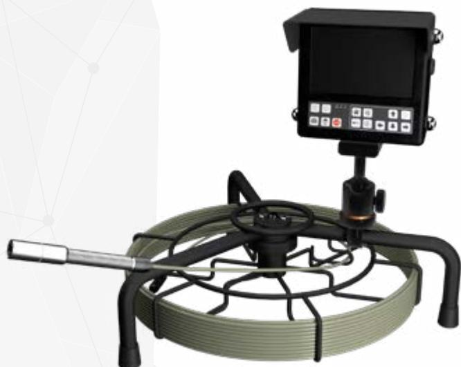
La Tubicam® R-TT peut être combiné avec la régie compact. Cet équipement vous permet des inspections dans les diamètres de  $\varnothing 30$  mm à  $\varnothing 200$  mm, sur une longueur 40 mètres.
