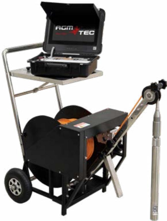
La Foracam® a été spécialement conçue pour les professionnels du forage. Grâce à sa tête de caméra axiale / radiale rotative, elle permet des inspections dans les réseaux de  $\varnothing 80$  mm à  $\varnothing 1200$  mm de diamètre et jusqu'à 500 mètres de profondeur (490 mètres de colonne d'eau).
