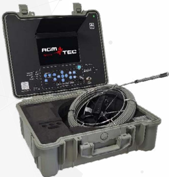
Utilisable par un seul opérateur, la caméra d'inspection Tubicam® R14 est idéale pour visualiser les petites canalisations et les tuyaux de piscines grâce à sa tête Ø14 mm sur des diamètres allant de Ø20 mm à Ø70 mm, jusqu'à 30 mètres de distance.
