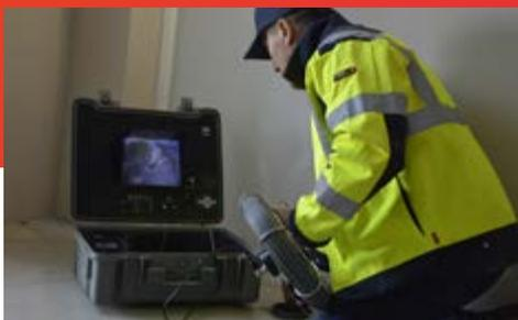
La gamme Tubicam® est composée de caméras d'inspection de canalisations sur joncs à pousser.
